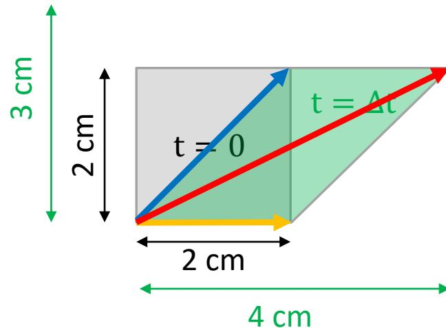
$$\begin{bmatrix} F_{11} & F_{12} \\ F_{21} & F_{22} \end{bmatrix} \begin{bmatrix} 2 \\ 0 \end{bmatrix} = \begin{bmatrix} 2 \\ 0 \end{bmatrix} \quad F_{ij} \quad \rightarrow \quad [2,0]$$
