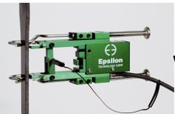
Load cell과 extensometer는 전기적 신호를 준다. 전기적 신호와 실제 physical quantity (Force 혹은 길이 변화)는 calibration을 통해 변환 시킨다.
